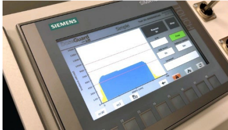
Benutzerdefinierte obere und untere Grenzwerte können voreingestellt werden, um das Ergebnis (bestanden/nicht bestanden) eindeutig anzuzeigen.
